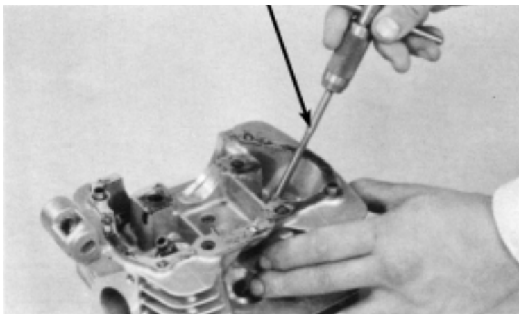
ALARGADOR DA GUIA DE VÁLVULA, 5,485 mm
