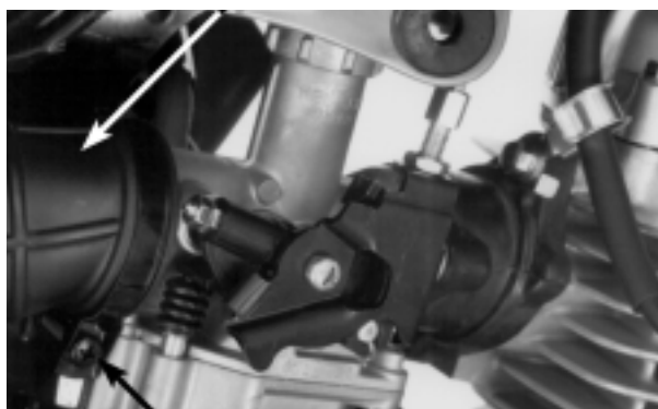
PARAFUSO DA BRAÇADEIRA DO TUBO DE CONEXÃO
