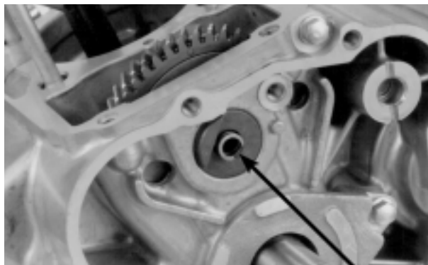
MOLA DA ÁRVORE DE COMANDO EIXO DA ENGRENAGEM DE COMANDO
