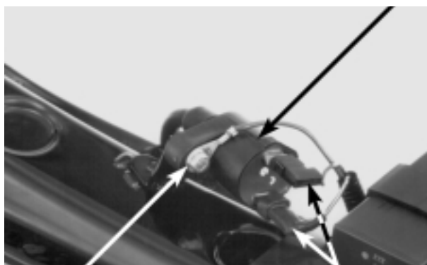
PARAFUSO CONECTORES MÓDULO DE CONTROLE DA IGNIÇÃO
