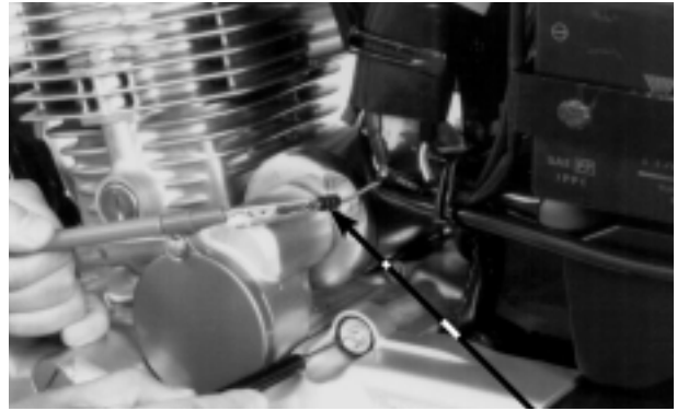
CONECTOR DO GERADOR DE PULSOS DA IGNIÇÃO
