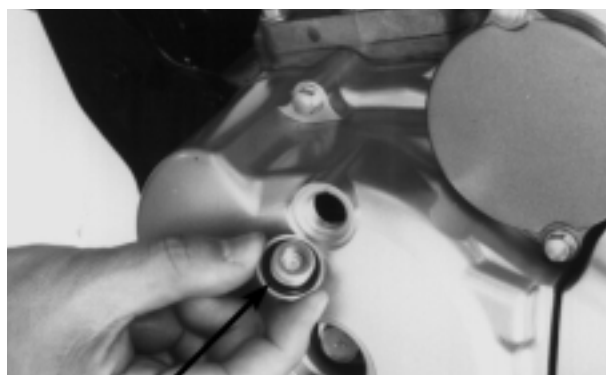
TAMPA DO ORIFÍCIO DE SINCRONIZAÇÃO LUZ ESTROBOSCÓPICA
