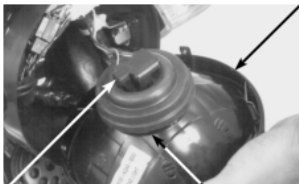
CONECTOR DA LÂMPADA DO FAROL
