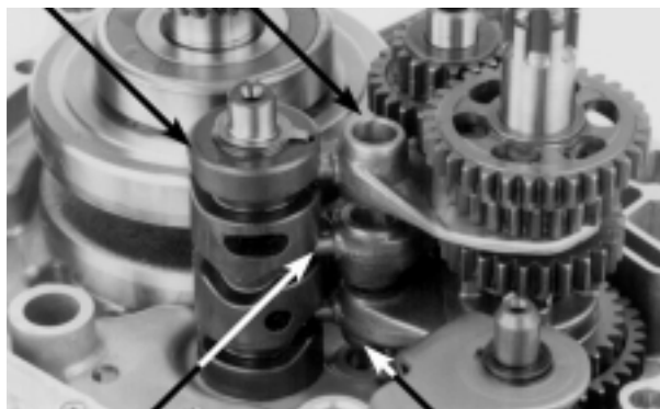
GARFO SELETOR CENTRAL GARFO SELETOR DIREITO EIXO DOS GARFOS SELETORES
