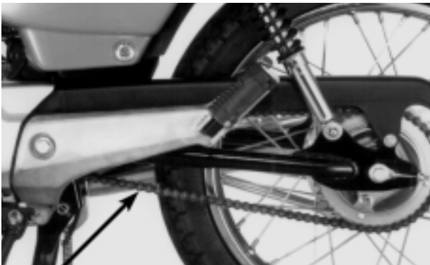
CORRENTE DE TRANSMISSÃO PRESILHA DE RETENÇÃO
