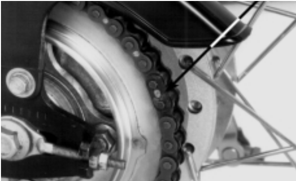
CORRENTE DE TRANSMISSÃO PRESILHA DE RETENÇÃO
