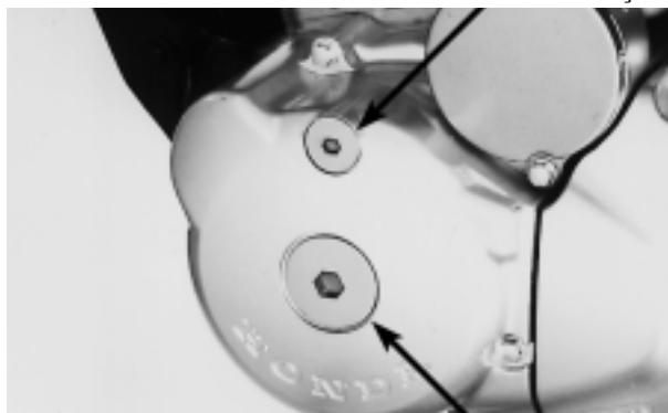
TAMPA DO ORIFÍCIO DA ÁRVORE DE MANIVELAS
